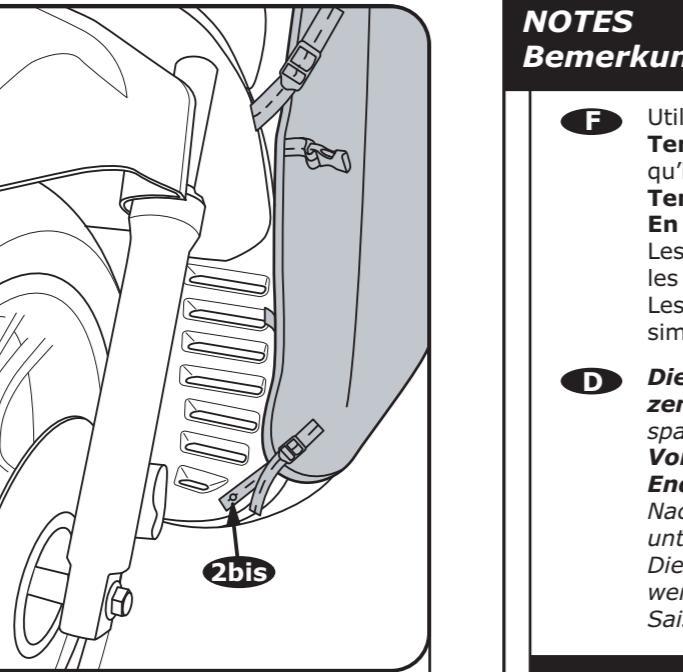
**D** Termoscud® auf beiden Seiten befestigen und dazu die Schrauben des Scooters benutzen (in der Radöffnung). Die Schrauben zu diesem Zweck durch die Öffnungen auf den Bändern 2bis stecken.
